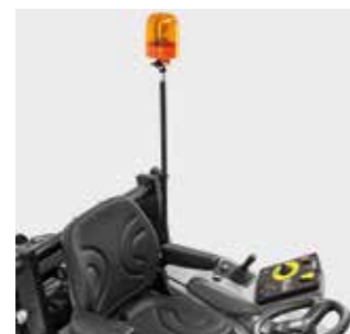
Rotacijsko svjetlo Potrebno ga je pričvrstiti izravno na stroju ili na zaštitnom pokrovu za vozača. Za veću sigurnost operatera i okolne površine.
