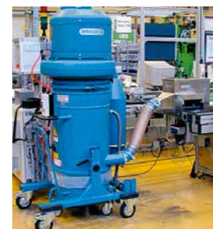
Uređaj za otprašivanje integriran u proizvodne linije
