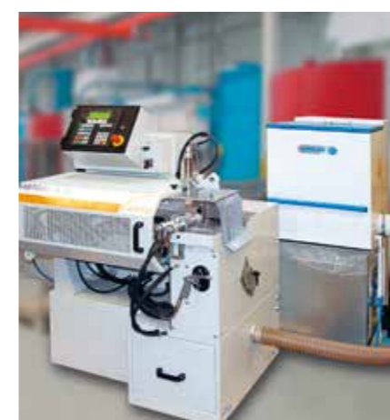
Uređaj za otprašivanje na pilama
