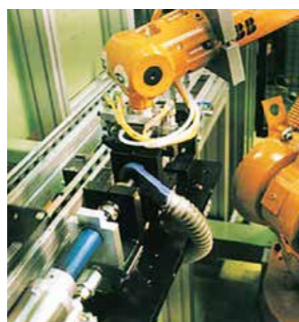
Ringler usisna mlaznica za točno usisavanje strugotina od glodanja
