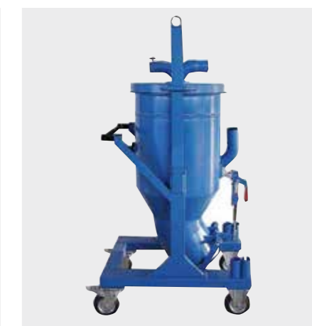
Predseparator od 110 l s poklopcem, ušicama za dizalicu, pomičan, transport viličarom, pražnjenje preko zaklopke, za rasute terete, pijesak, sivi lijev itd.
