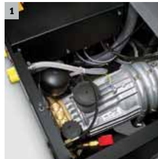
Wassergekühlter 4-poliger Elektromotor
