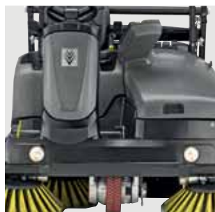
Arbeitsbeleuchtung und StVZO Zum Fahren bei Dämmerung oder in öffentlichen Bereichen.
